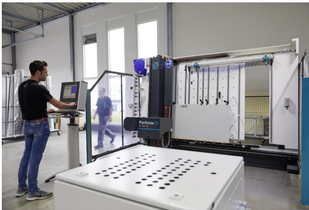
Bild 2 | Das Bearbeitungszentrum Perforex BC von Rittal übernimmt vollautomatisch das Bohren, Fräsen und Gewindeschneiden an Flachteilen und Gehäusen.
