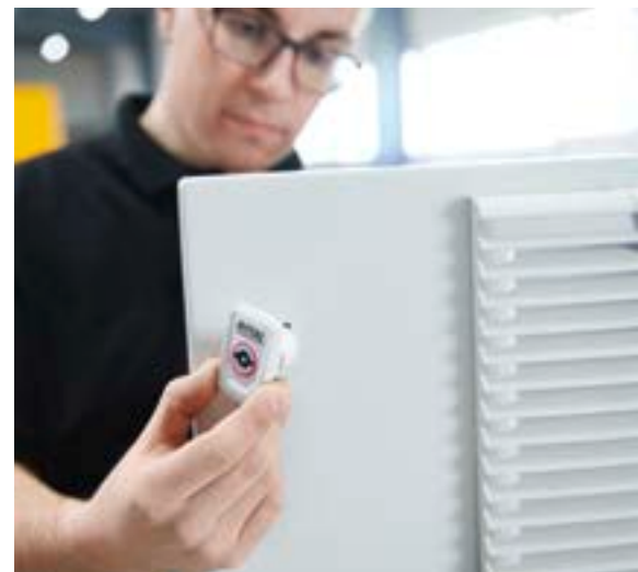
Werkzeuglos: 30 Prozent schnellere Montage: durch werkzeuglosen Einbau des Griffsystems.
