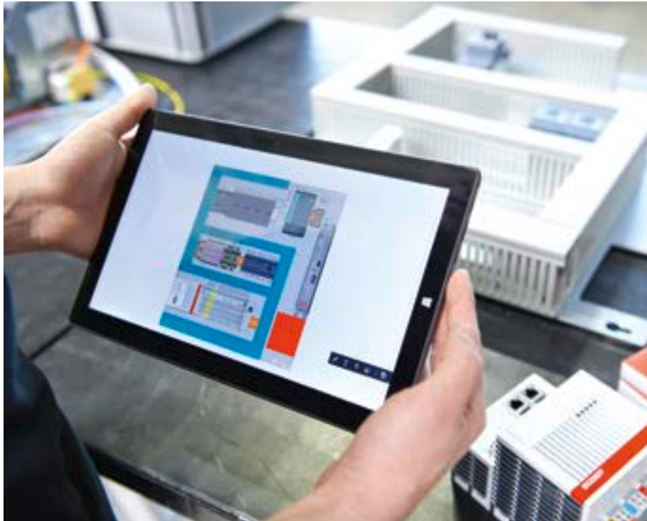
Digitaler Zwilling: Die Fertigungsdaten des digitalen Zwillings im Eplan Pro Panel.
